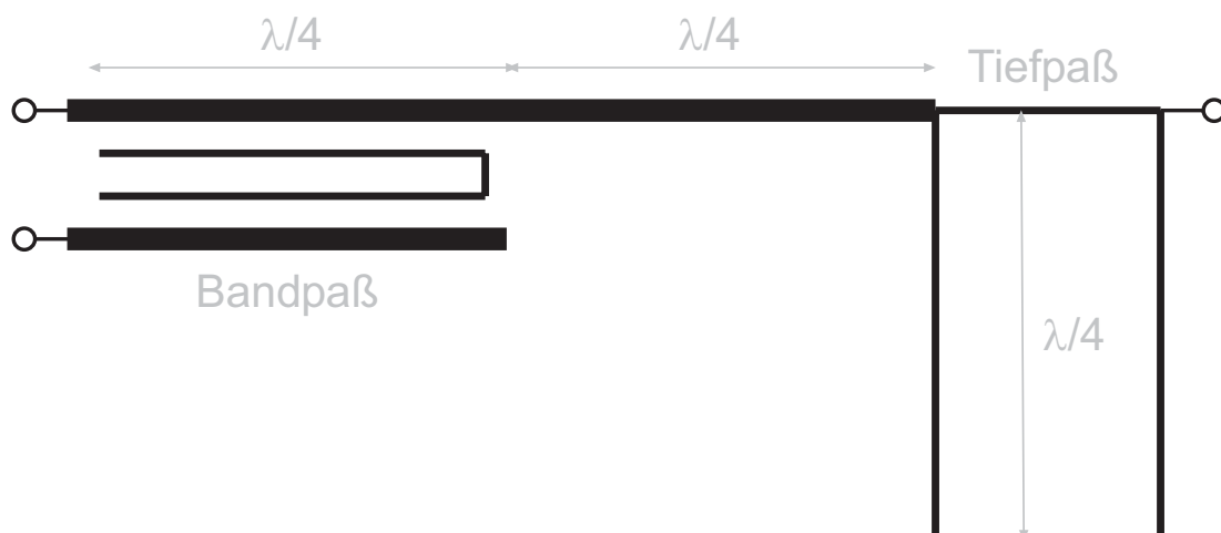
Bild 3 Kaskadierbares Bandpaß-/Tiefpaß-Element zur Auskopplung eines Frequenzbands
